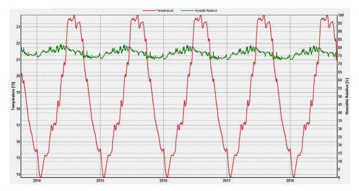
La teneur en eau diminue progressivement et atteint un maximun de 2.40% d'eau ce qui est très faible. Il n'y a aucun risque de formation d'un point de rosée dans cette couche puisque l'humidité relative ne dépasse pas 80%.
