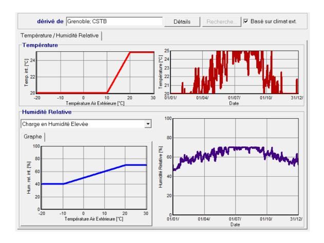
La température varie bien dans ce cas comme recommandé entre 20 et 25°C suivant la saison. L'humidité a été placée en charge élevée pour prendre en compte l'occupation des locaux avec des variations entre 40 et 70% d'humidité relative afin de prendre en compte les conditions les plus pénalisantes.
