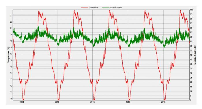
La teneur en eau diminue progressivement et atteint un maximun de 0.02% d'eau ce qui est très faible. Il n'y a aucun risque de formation d'un point de rosée dans cette couche puisque l'humidité relative ne dépasse pas 80%.
