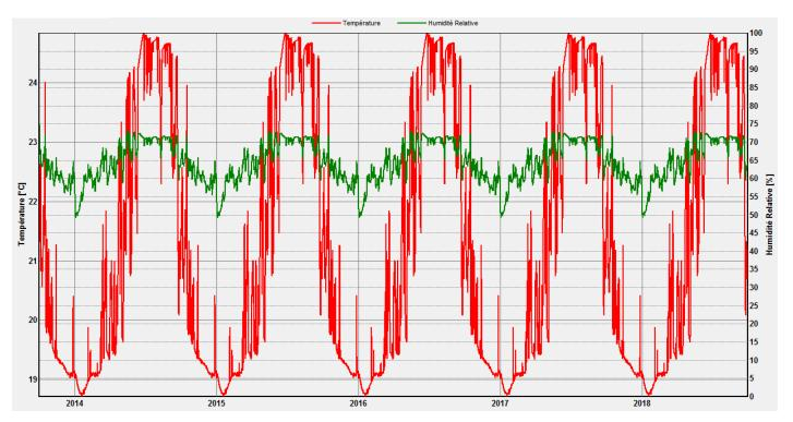
La teneur en eau diminue progressivement et atteint un maximun de 0.02% d'eau ce qui est très faible. Il n'y a aucun risque de formation d'un point de rosée dans cette couche puisque l'humidité relative ne dépasse pas 72%.
