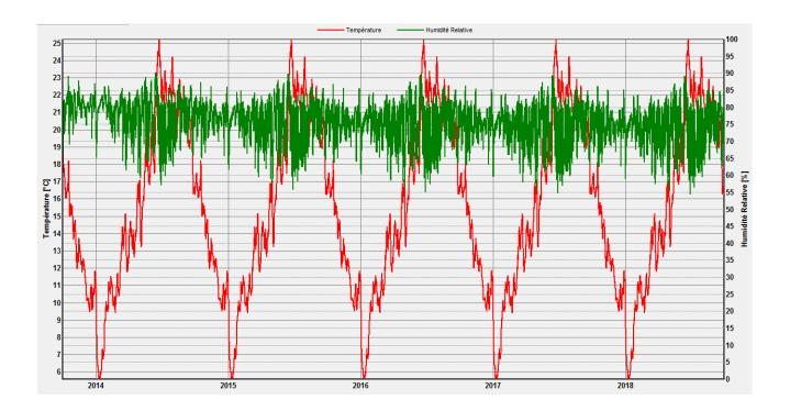
La teneur en eau diminue progressivement et atteint un maximun de 0.02% d'eau ce qui est très faible. Il n'y a aucun risque de formation d'un point de rosée dans cette couche puisque l'humidité relative ne dépasse pas 88%.
