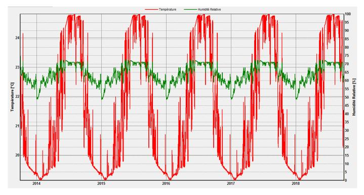
La teneur en eau diminue progressivement et atteint un maximun de 0.01% d'eau ce qui est très faible. Il n'y a aucun risque de formation d'un point de rosée dans cette couche puisque l'humidité relative ne dépasse pas 72%.
