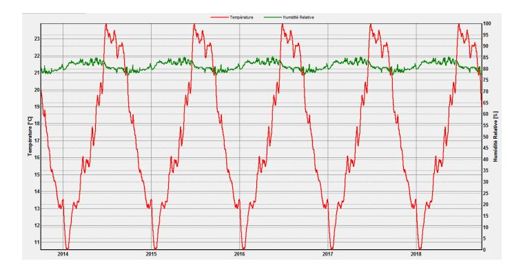
La teneur en eau diminue progressivement et atteint un maximun de 2.46% d'eau ce qui est faible. Il n'y a aucun risque de formation d'un point de rosée dans cette couche puisque l'humidité relative ne dépasse pas 85%.
