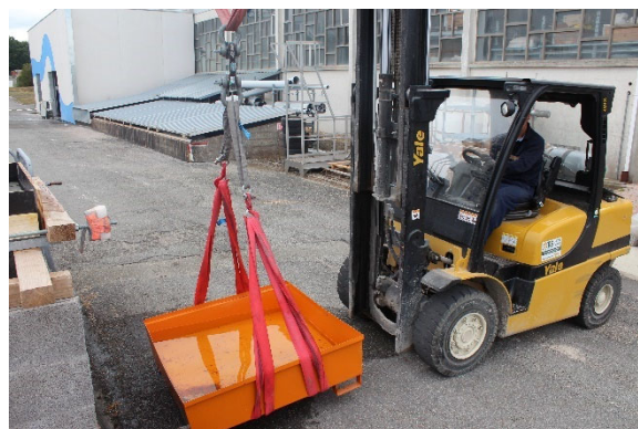
Pesée du bac de récupération de l'eau
