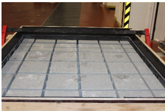
Dalles gazon mises en place sur la grille support recouverte d'un géotextile et système d'étanchéité latérale mis en place
