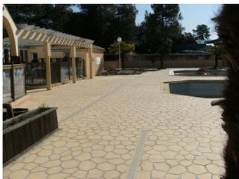
Ce béton est **imprimé par la technique du pochoir**. Il est réalisé par la mise en place d'une trame en carton hydrofuge qui matérialise les joints, le saupoudrage et l'application d'un colorant durcisseur de surface sur béton frais. La trame se décline en **plusieurs finitions, pavés droits, pavés de Paris, dalles romaines...**
