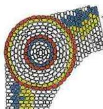
Montage associant une rosace et la pose en bandes, avec utilisation de pavés irréguliers de type vieillis.
